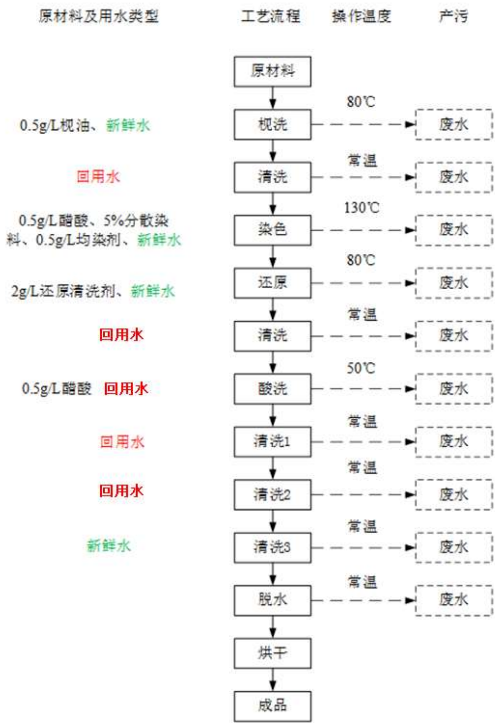
图 4.2-2 涤类（布料、织带）、筒子纱生产工艺流程
