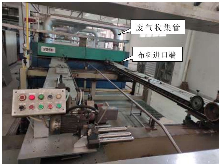
图 7.2-2 定型废气收集示意图
