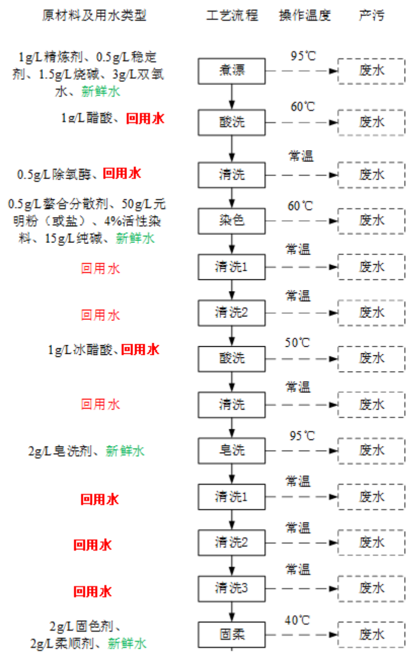
图 4.2-1 棉类（布料、织带）生产工艺流程
