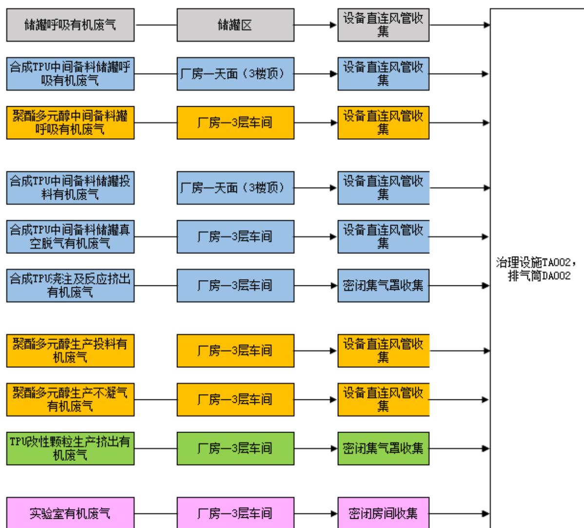
3.2-2 有机废气收集及治理系统示意图
