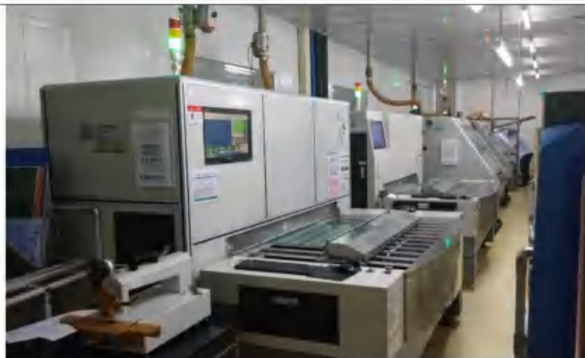
同类项目钻孔机、V-CUT 机、锣机等集尘措施实拍图
