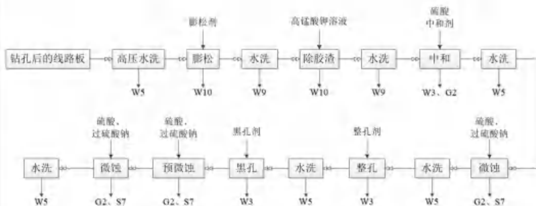
图 2.4-14 黑孔工艺流程
