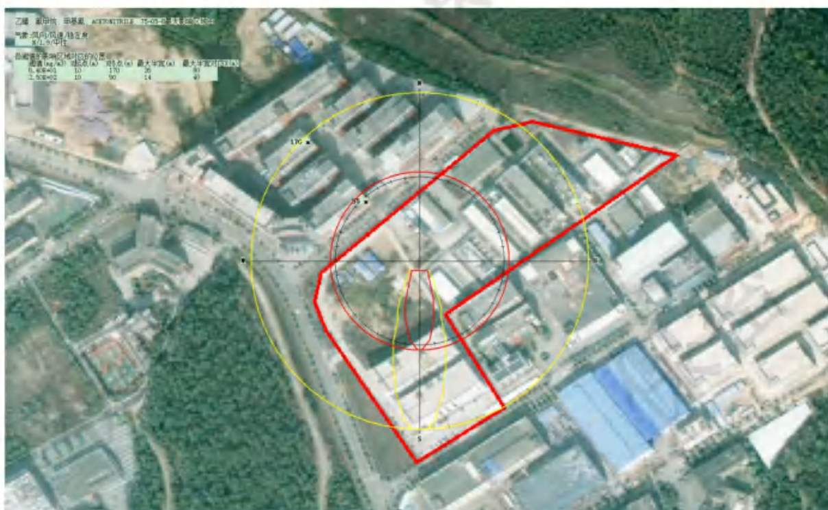
图 7.5-13 最常见气象条件下的乙腈泄漏蒸发事故情形影响区域范围图
