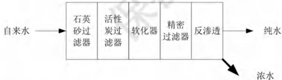
图 3.9-10 纯水制备工艺流程
