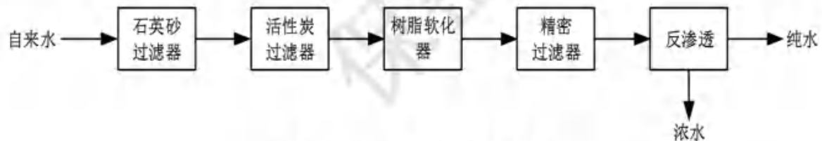
图 3.4-1 纯水制备工艺流程
