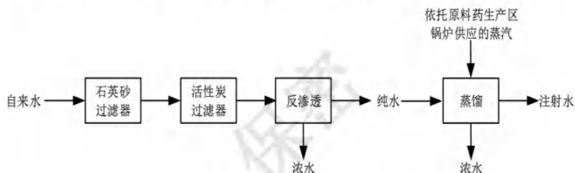
图 3.5-1 纯水、注射水制备工艺流程
