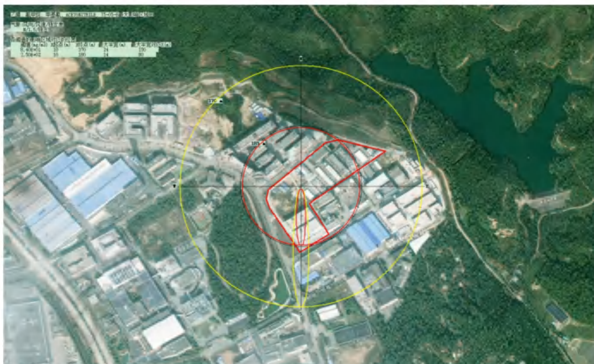
图 7.5-6 最不利气象条件下的乙腈泄漏蒸发事故情形影响区域范围图
