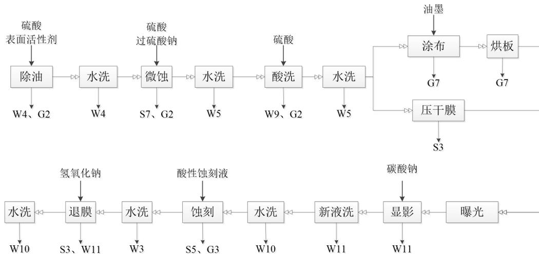
图 2.4-9 图形转移工艺流程图
