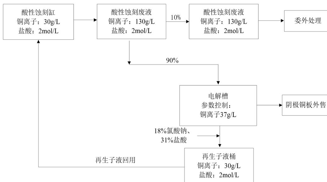
图 2.1-2 酸性蚀刻废液再生物料去向图
