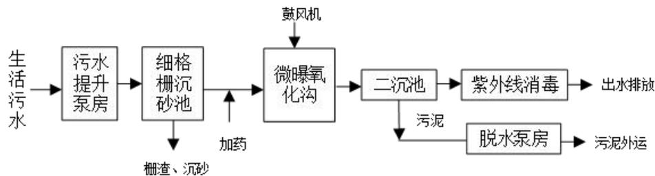
图 4.2.1-2 三角镇污水处理厂工艺流程图
