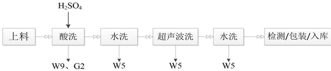
图 2.4-26 成品清洗工艺流程图
