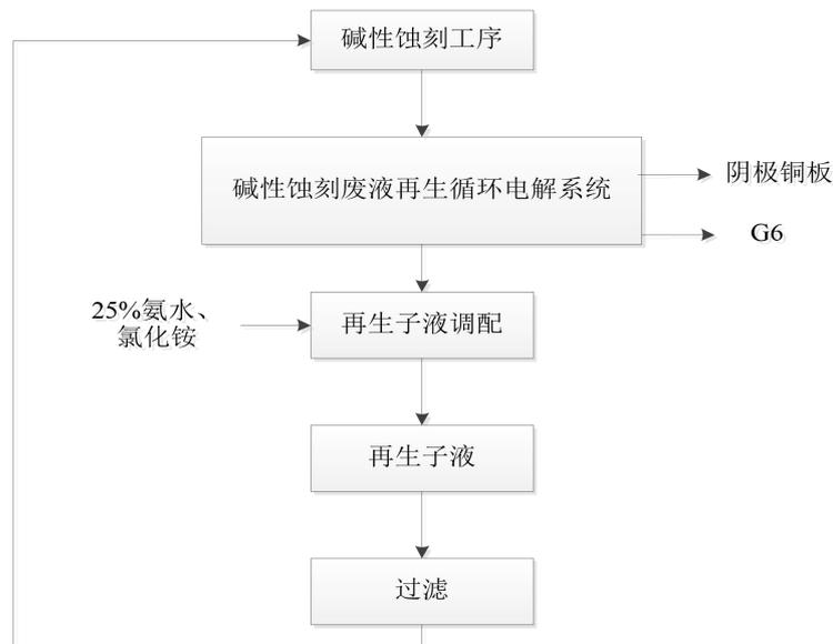
图 2.1-3 碱性蚀刻废液循环回收工艺
