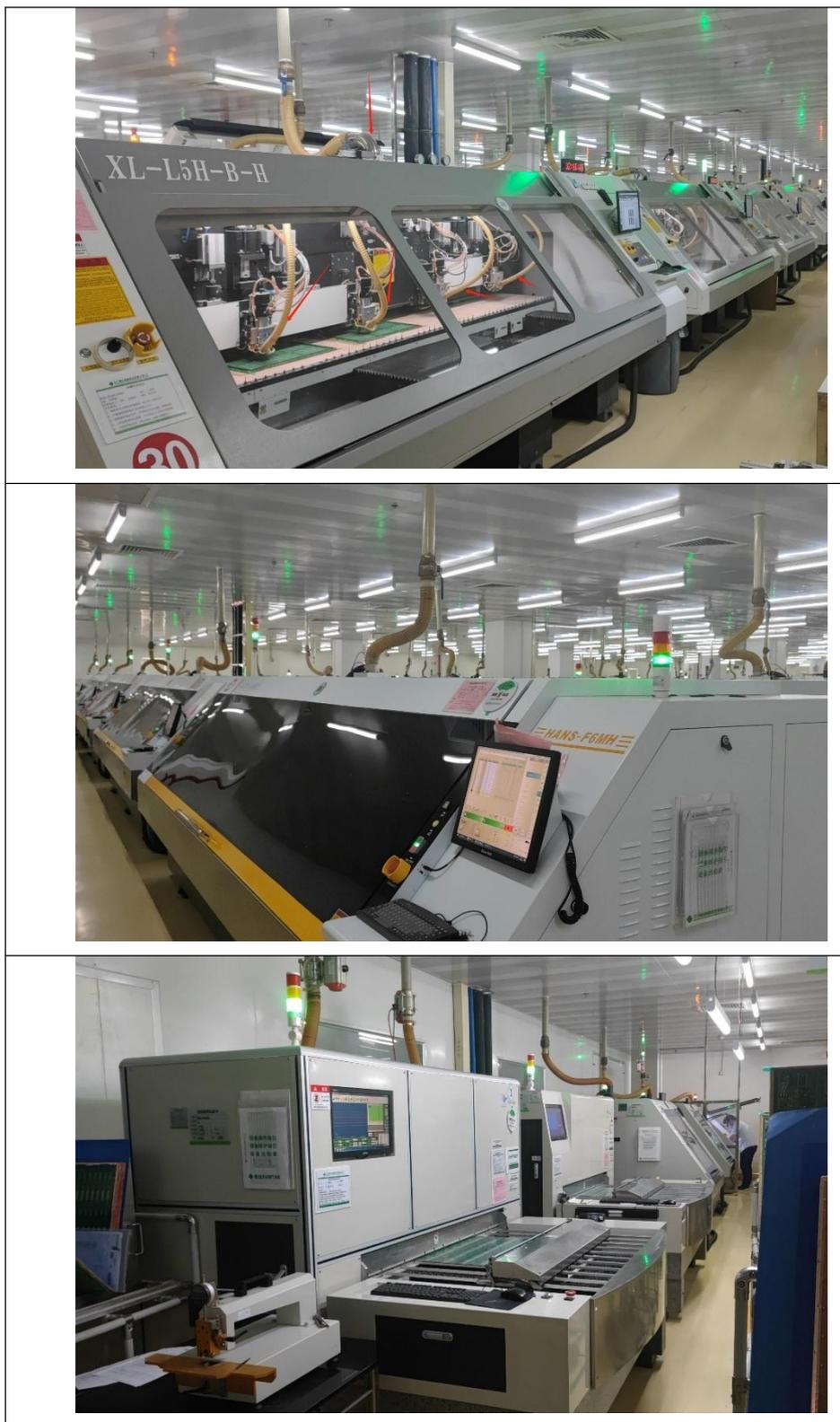
同类项目钻孔机、V-CUT机、锣机等集尘措施实拍图
