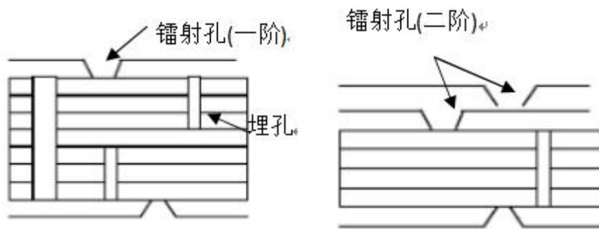
图 2.4-2 (a) 一阶 HDI 板      图 1.4-2 (b) 二阶 HDI 板
