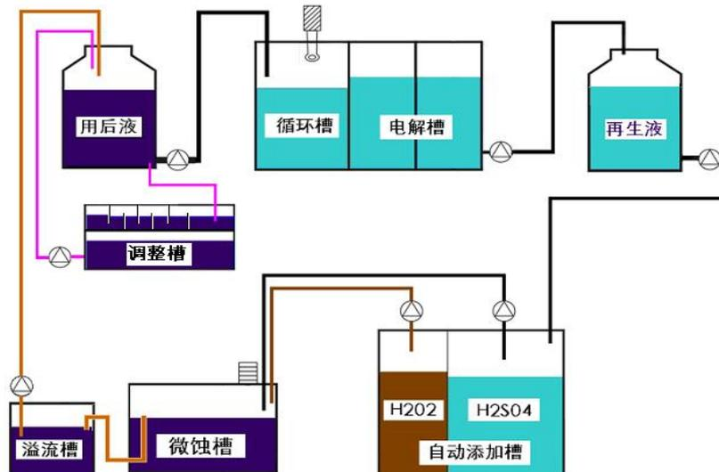
图 2.1-4 微蚀废液提铜系统工艺流程示意图
