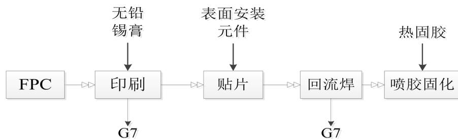
图 2.4-27 SMT 工序流程图
