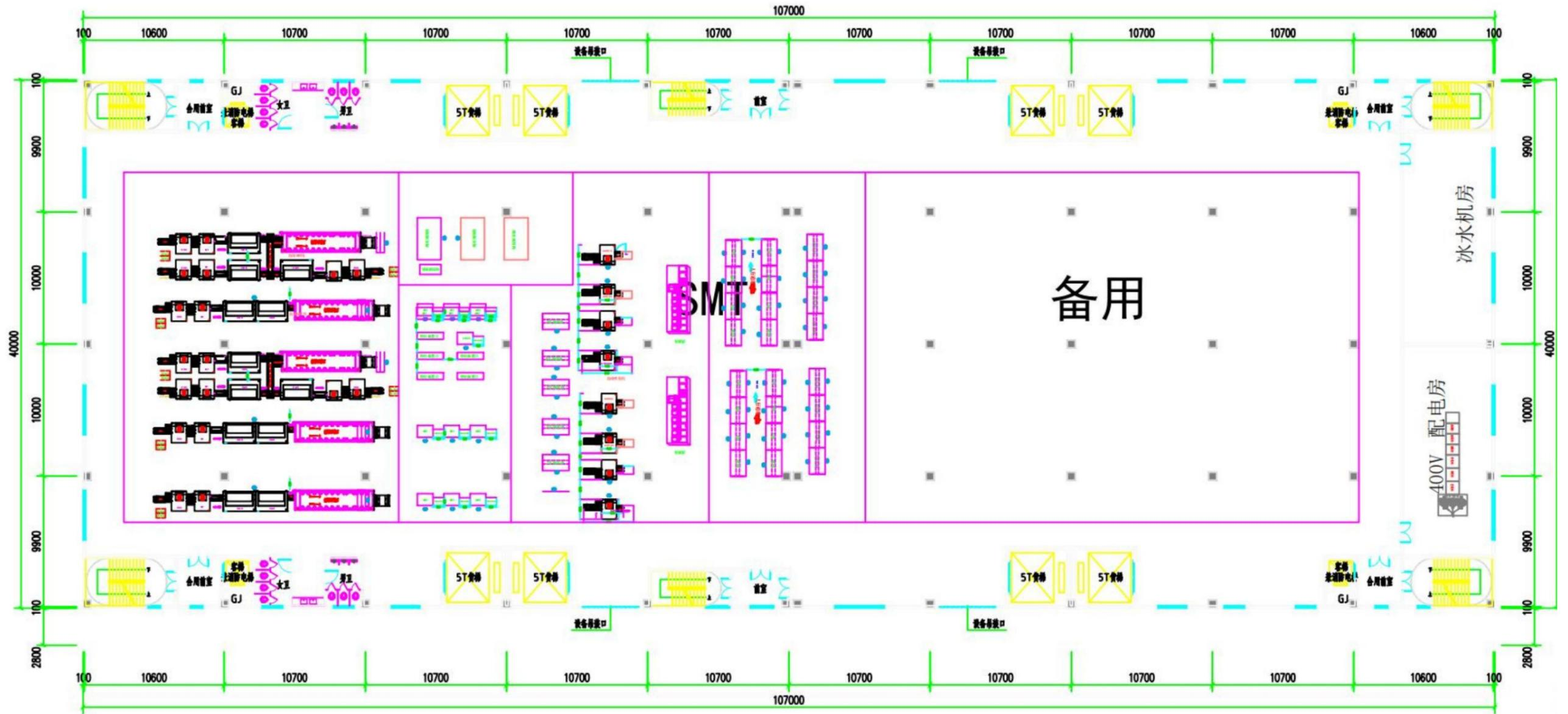
图 2 (7) 4#厂房平面布置图 (七层)
