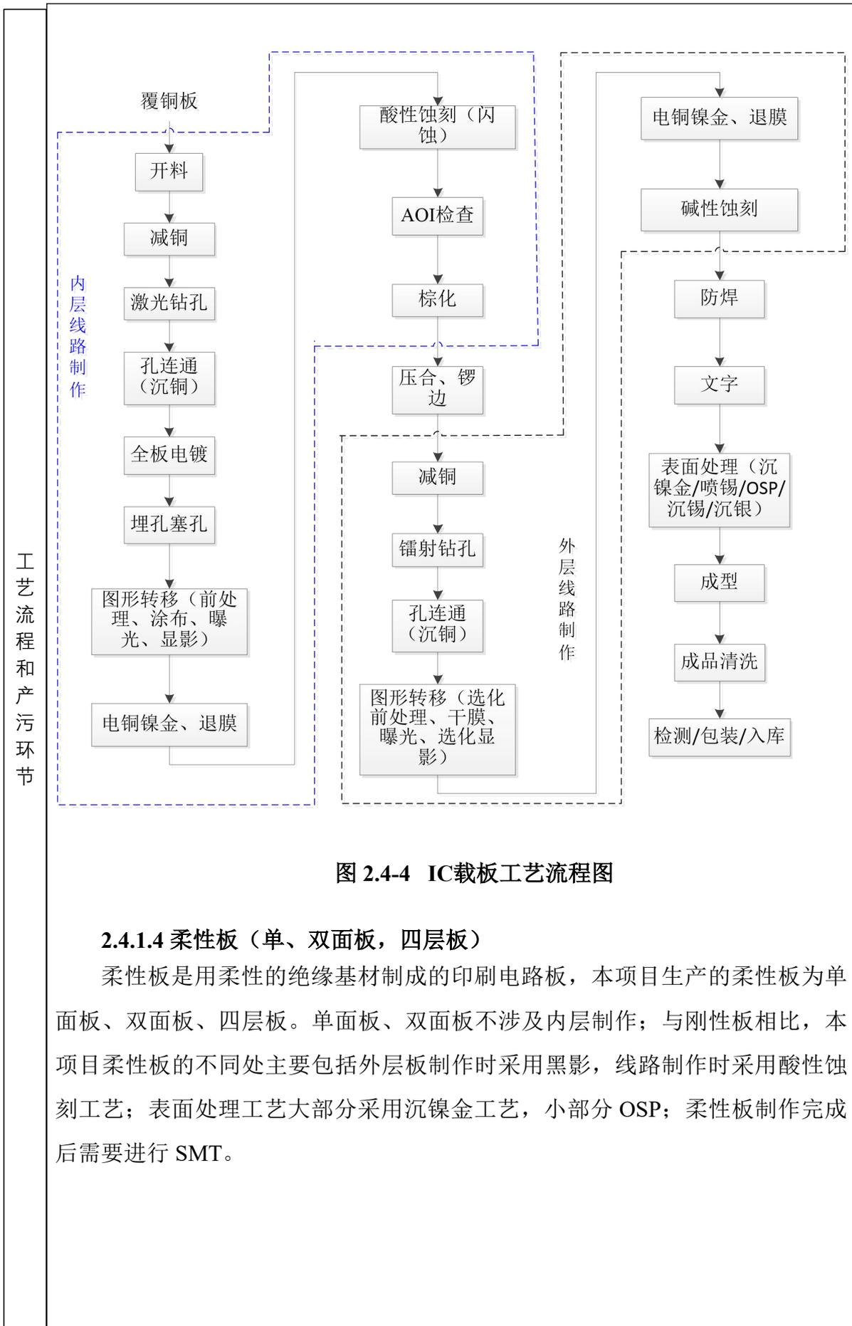
图 2.4-4 IC载板工艺流程图
