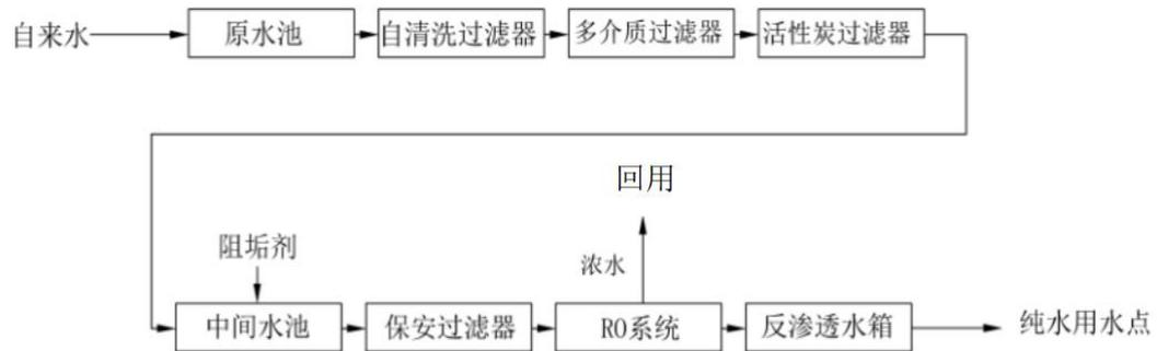
图 2.1-1 制纯水系统生产工艺流程图
