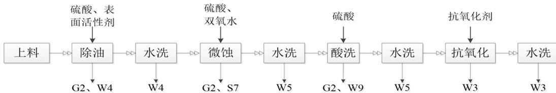
图 2.4-22 OSP工艺流程图
