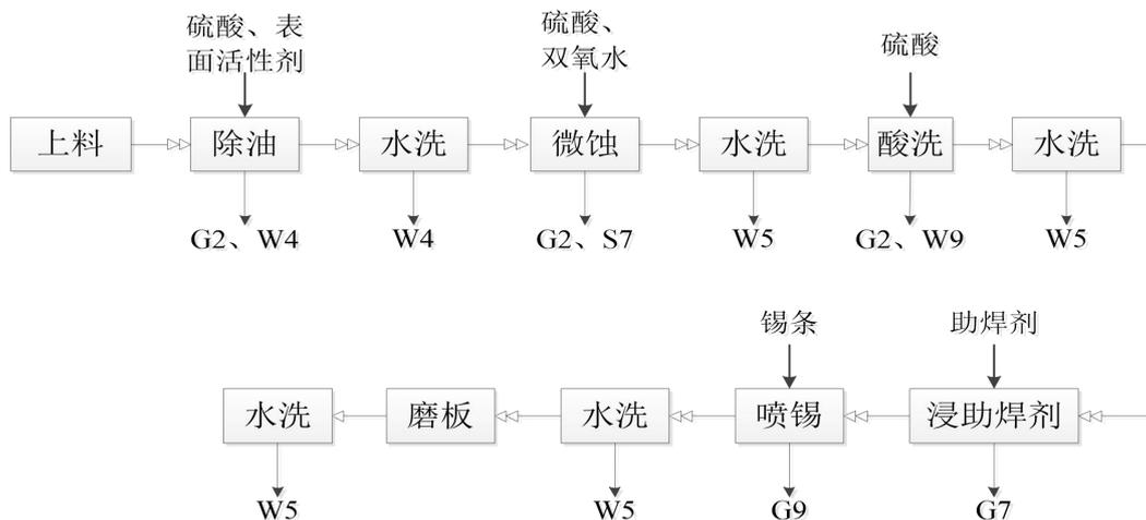
图 2.4-21 喷锡工艺流程图
