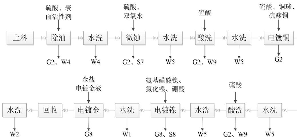
图 2.4-25 电铜镍金工艺流程图
