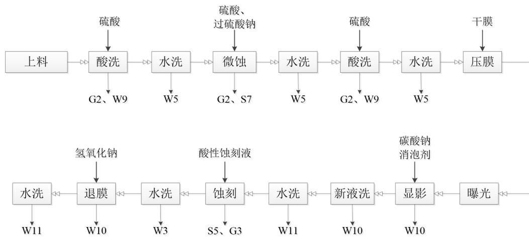
图 2.4-17 外层线路（负片工艺）工艺流程
