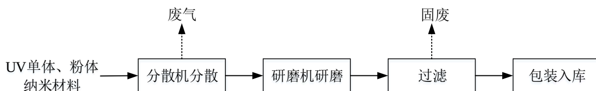
图 4.3-18 无溶剂法纳米树脂生产工艺流程及产污环节
