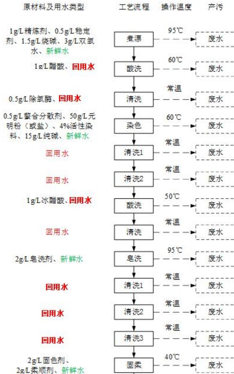
图 4.2-1 棉类（布料、织带）生产工艺流程
