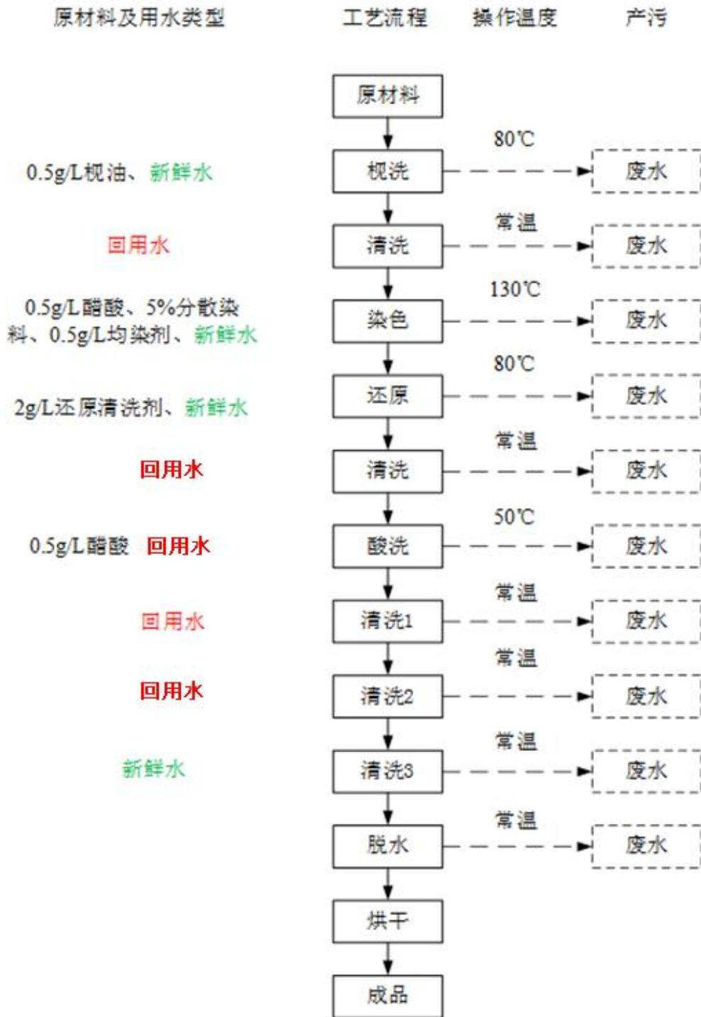
图 4.2-2 涤类（布料、织带）、筒子纱生产工艺流程
