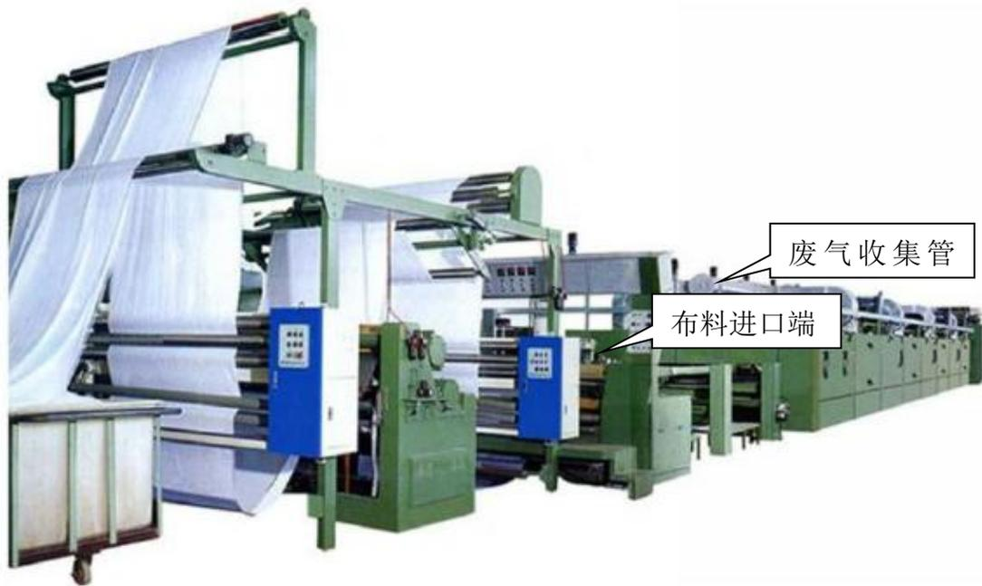
图 7.2-1 定型机结构图
