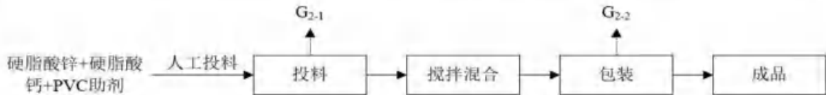
图 3.3-2 无毒热稳定剂生产工艺流程
