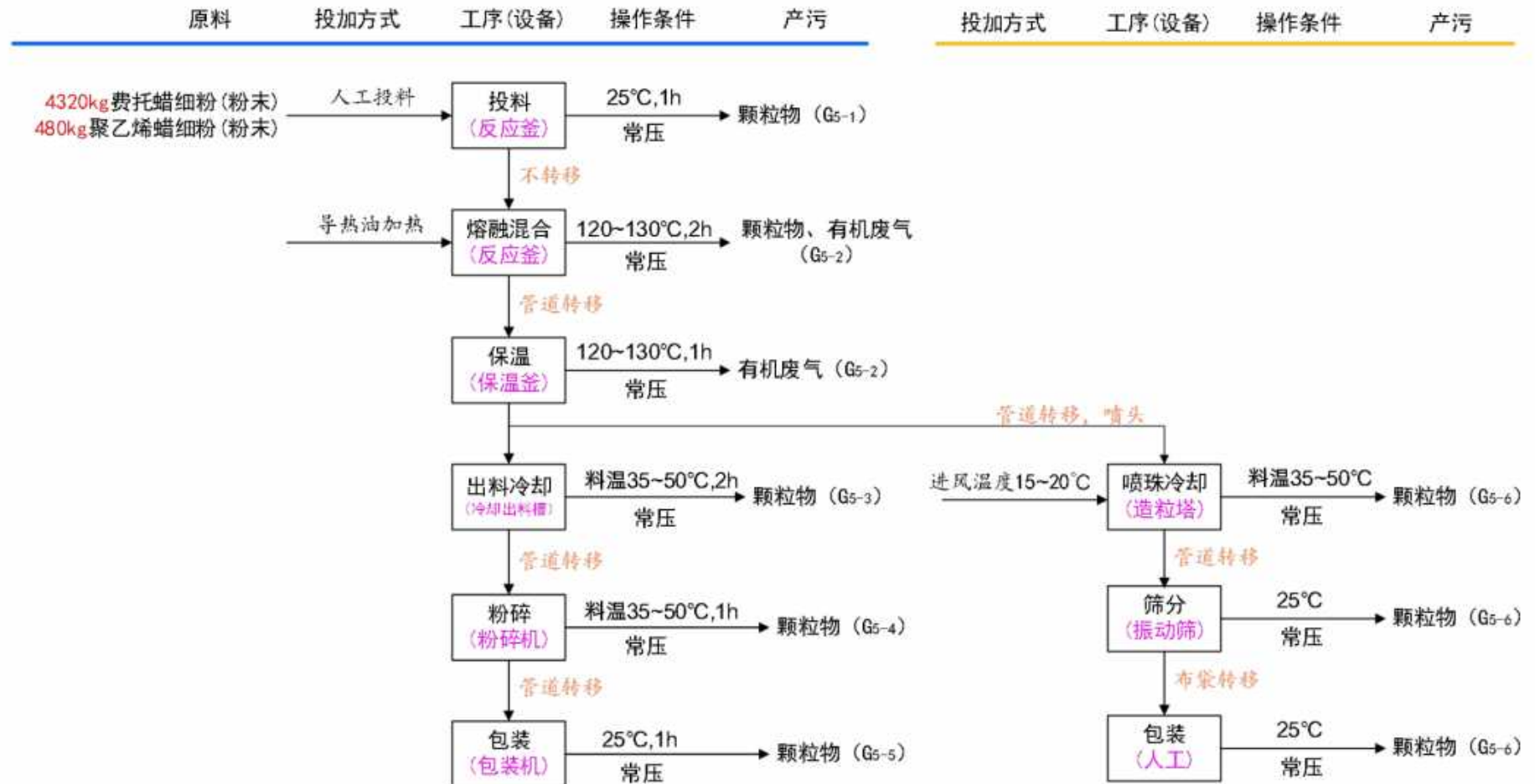
费托蜡工艺流程图（硬脂酸盐厂房）
