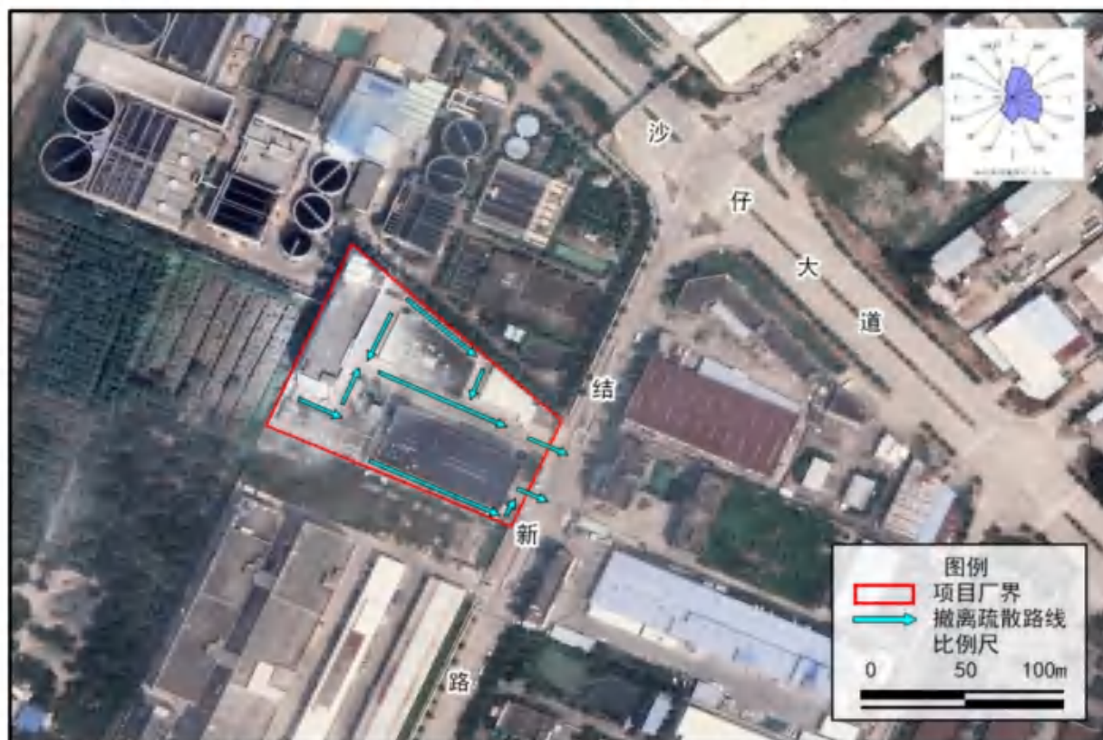
图 7.6-1 厂区内应急疏散路线图
