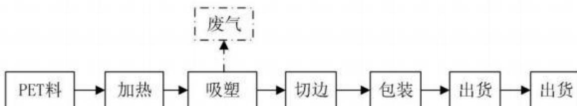
工艺说明：PET片材经加热后吸塑，加热温度为 50~60℃，加热只作为软化 PET 片材，不产生有机废气，加热后进行吸塑成型，吸塑过程中会产生有机废气，吸塑后切边即可包装成品出货。
