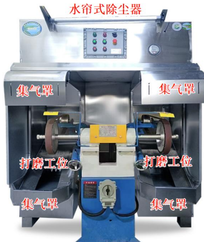
图 4.2.4-1 水帘式除尘器示意图
