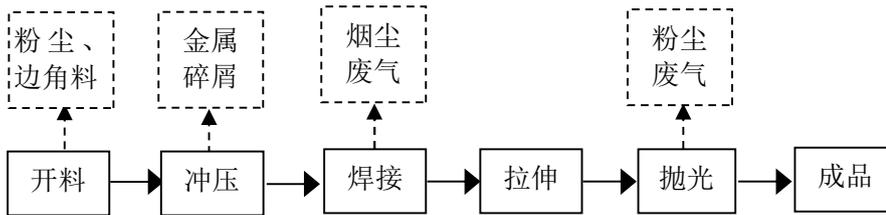
图4 生产工艺流程图
