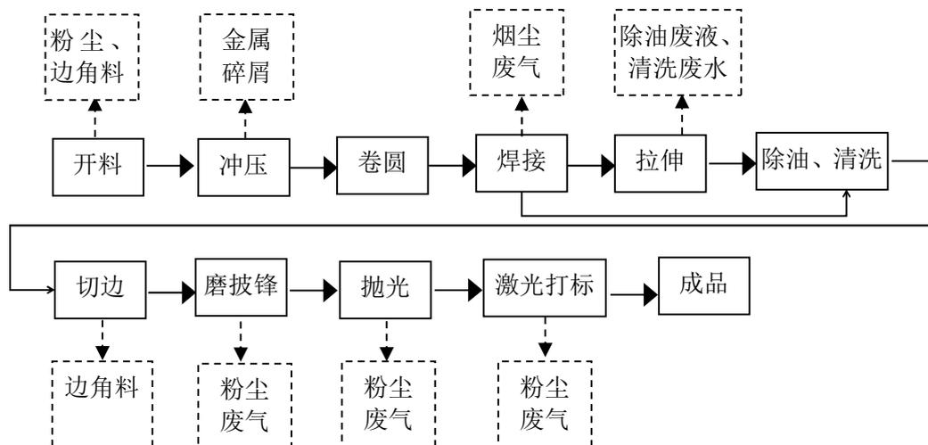
图3 生产工艺流程图
