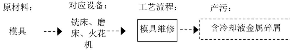
图 6 模具维修生产工艺流程图
