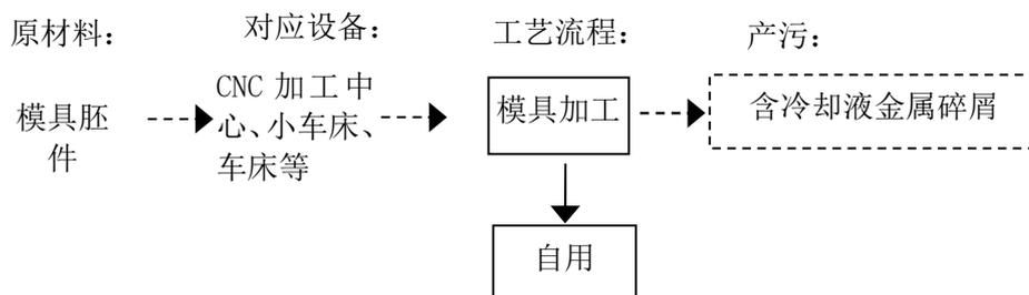
图5 模具生产工艺流程图
