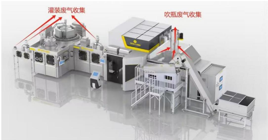
图 2-1 吹灌旋一体机示意图
