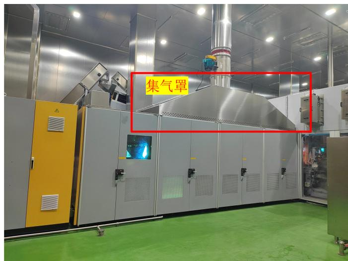
**图 4-1 吹瓶废气收集方式示意图**
