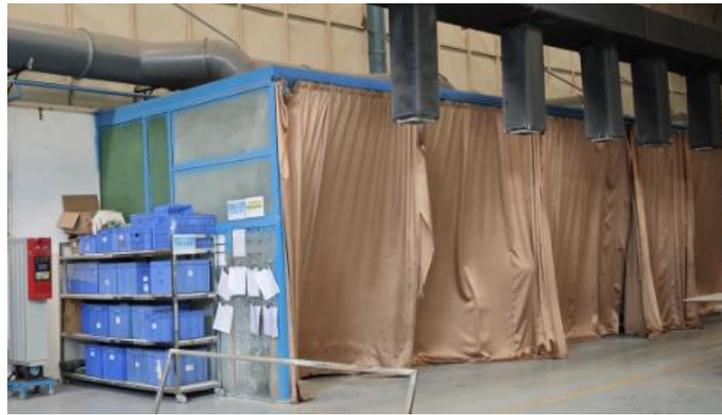
图 4-1 科勒公司现有手动喷粉工序废气收集措施
