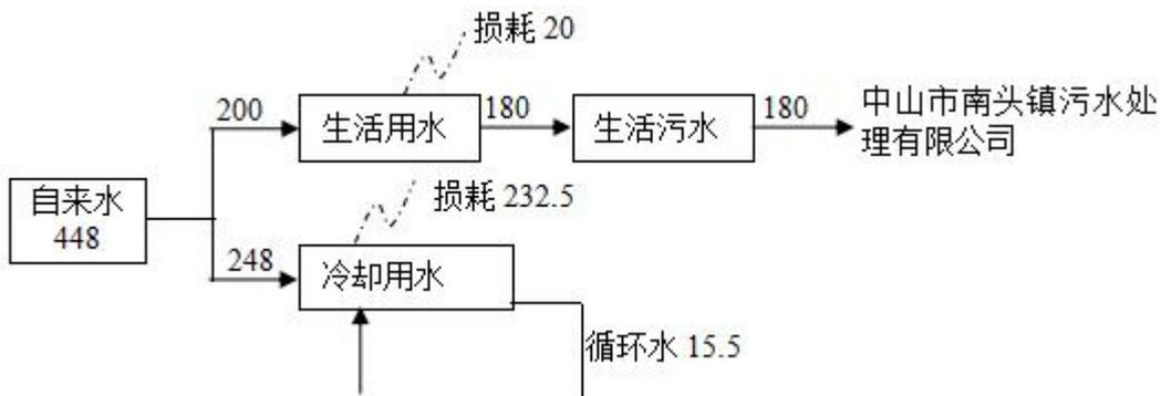
图 1 全厂水平衡图 (单位: t/a)
