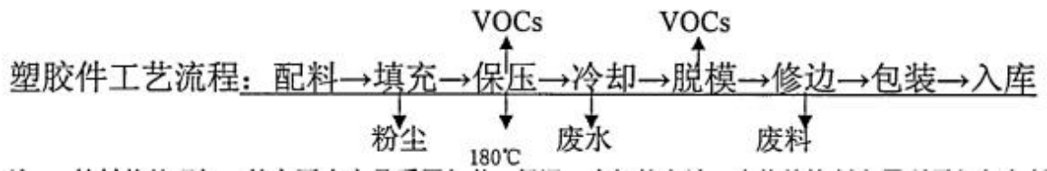
图2.17 塑胶件生产工艺流程图 (已批未建)
