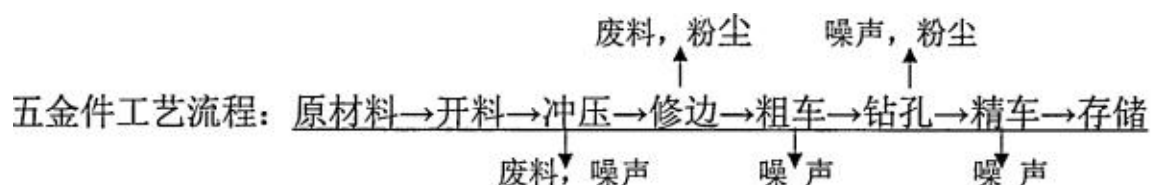
图2.16 五金件生产工艺流程图（已批未建）
