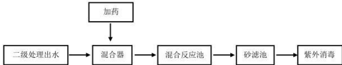
图 4-2 中山市小榄水务有限公司污水处理分公司三期工程废水处理工艺流程
