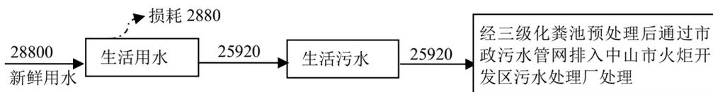
图 2-2 项目扩建后水平衡图 (m³/a)
