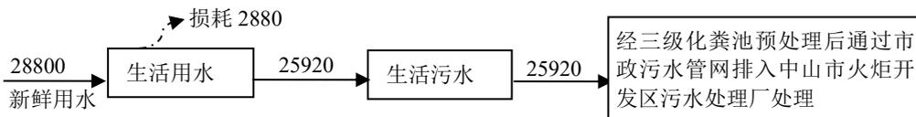
图 2-1 现有项目水平衡图 (t/a)
