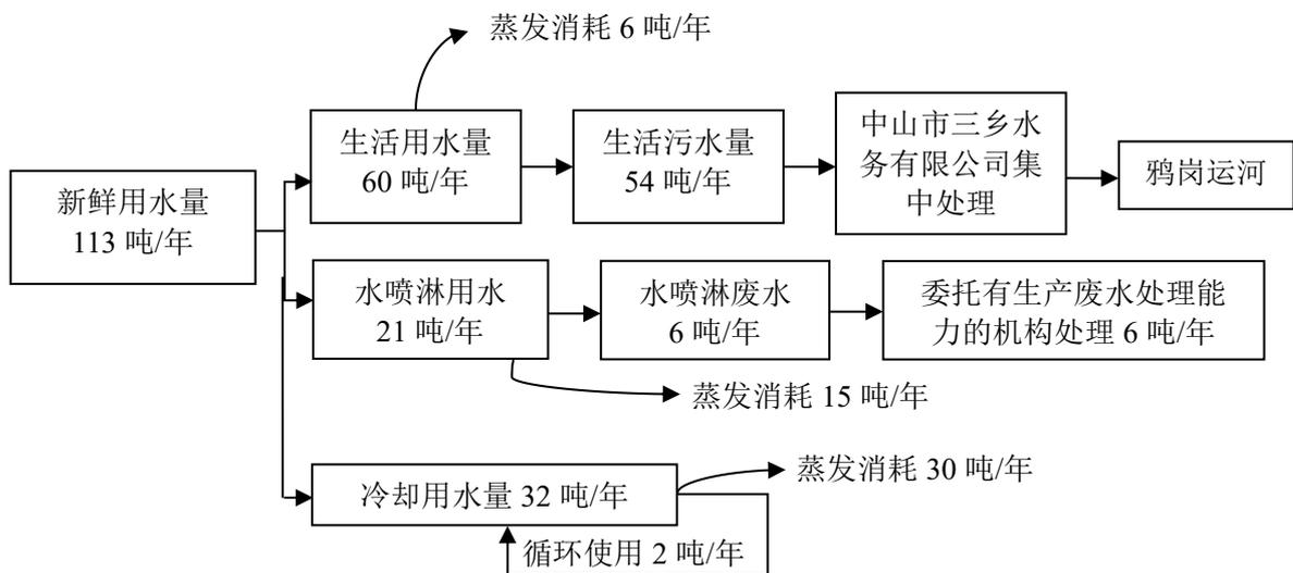
图 1 项目水平衡图
