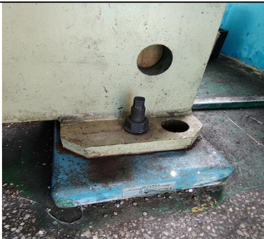
附图 4 高噪声设备配置橡胶减震块
