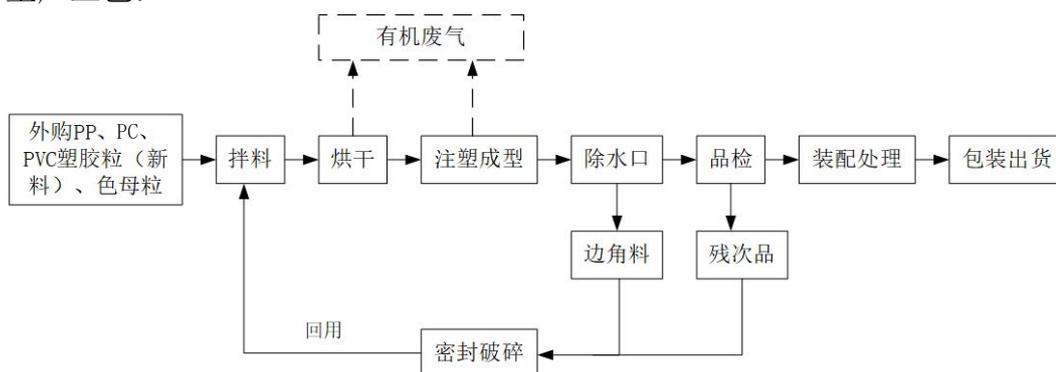
图 3 项目生产工艺流程及产污环节
