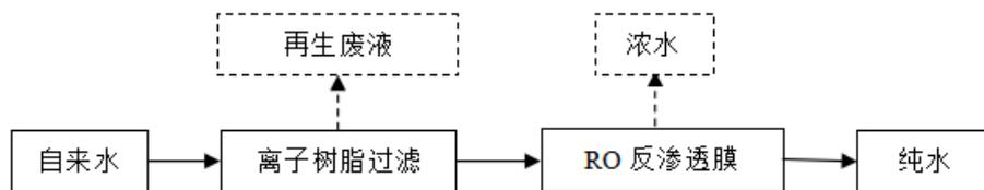
图 4 纯水制备生产工艺流程图及产污环节图
