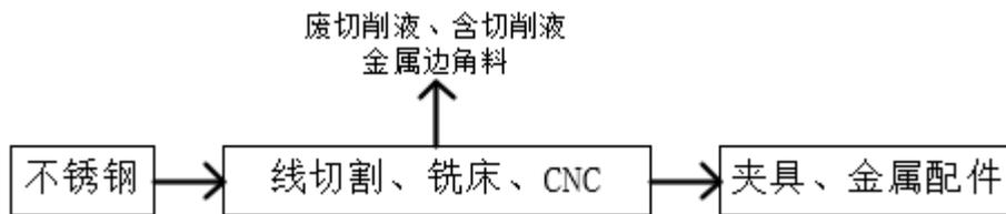
图 3 夹具、金属配件生产工艺流程图及产污环节图
