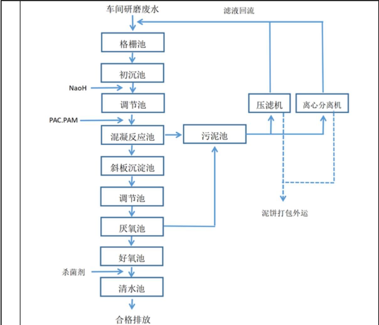
图 5 废水处理系统工艺流程图
