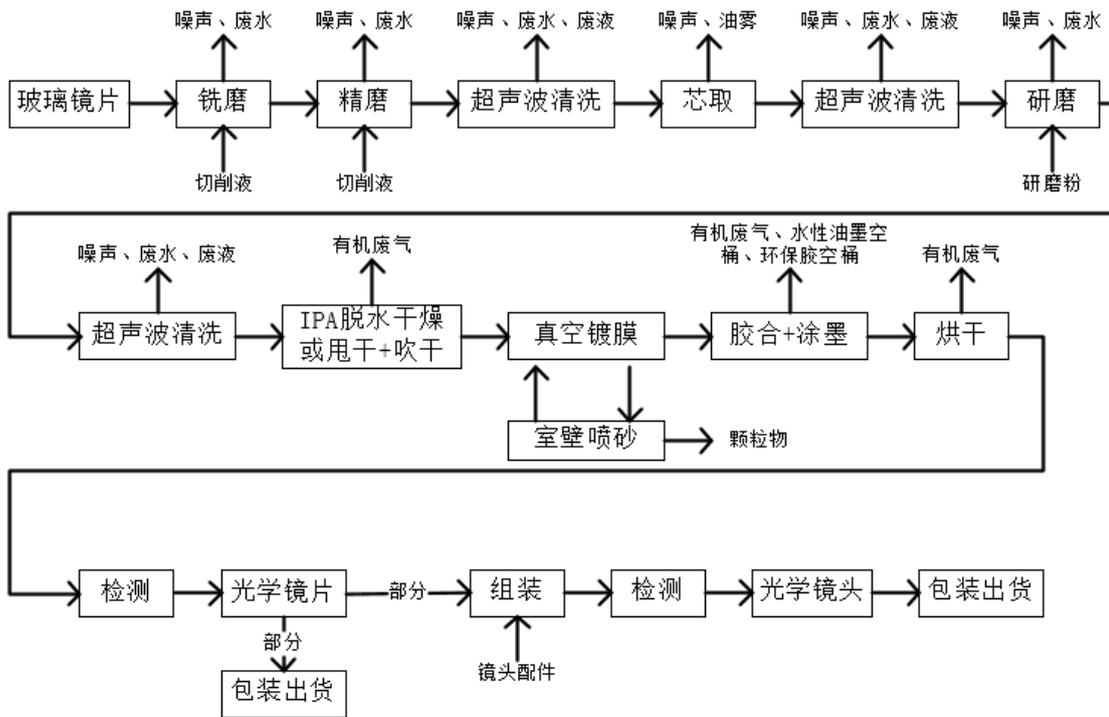
图 2 光学镜片/镜头生产工艺流程图及产污环节图
