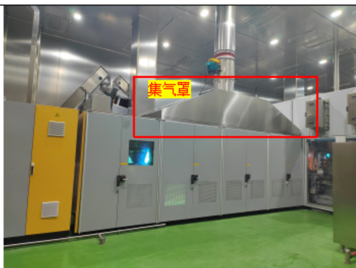
图 4-3 吹瓶废气收集方式示意图
