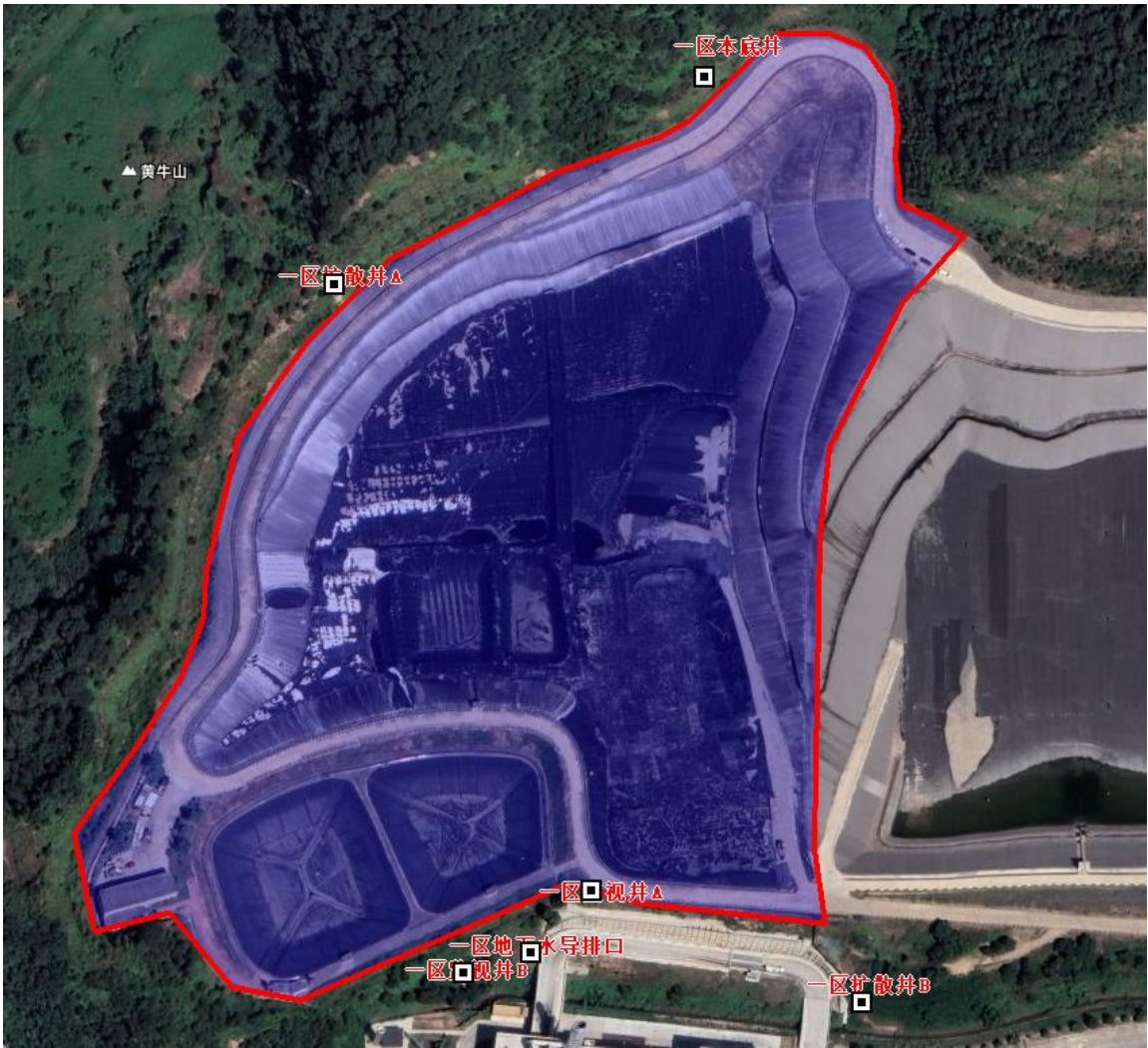
图 4.2-6 填埋场一区地下水跟踪监测井分布情况
