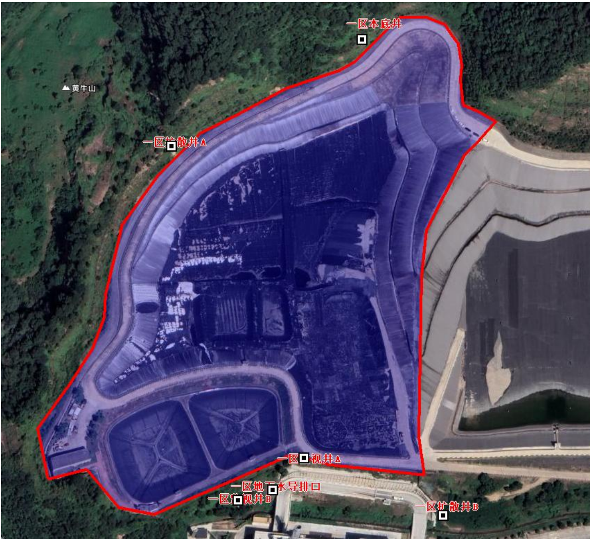
图 3.3-2 填埋场一区地下水跟踪监测井分布情况
