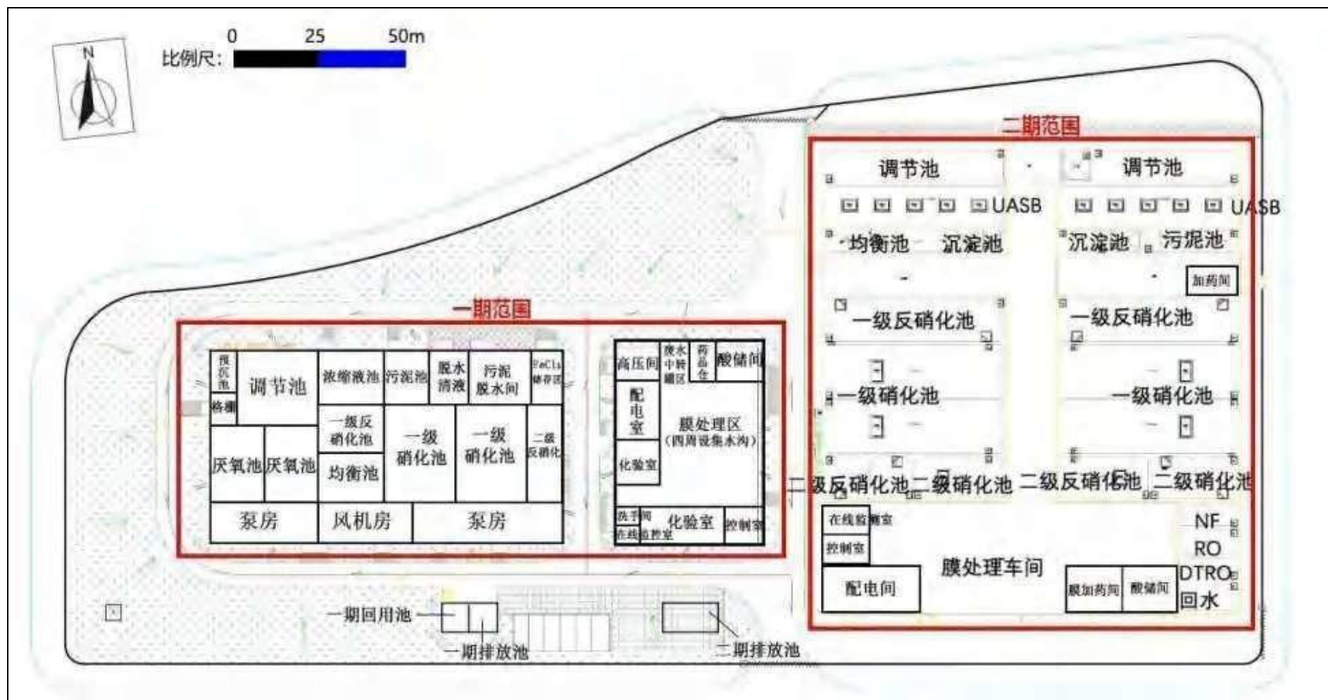
图 3.1-3 现有项目平面布置图（渗滤液厂区）
