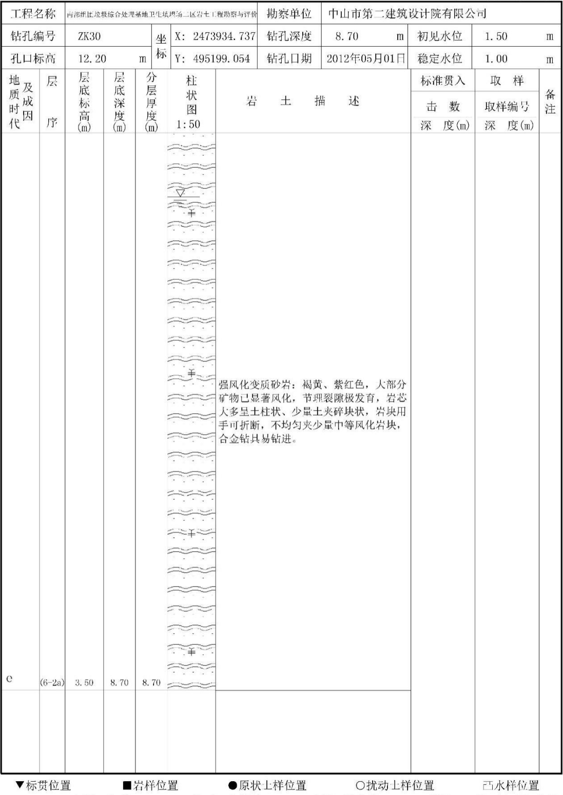
图 6.6-5 典型钻孔柱状图
