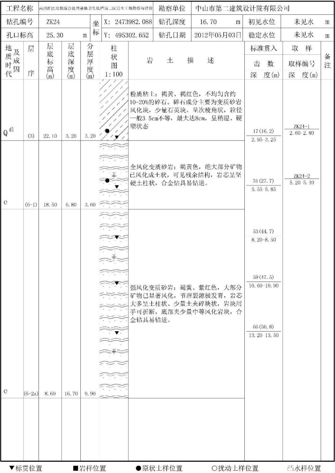
图 6.6-4 典型钻孔柱状图
