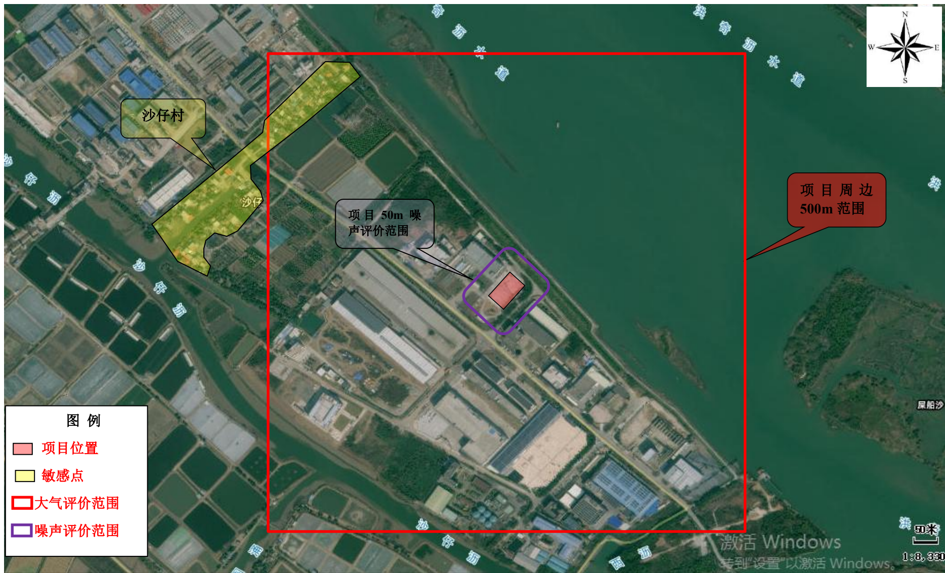
附图 9：建设项目 500m 范围内大气环境保护目标范围及 50 米范围内声环境保护目标范围图
